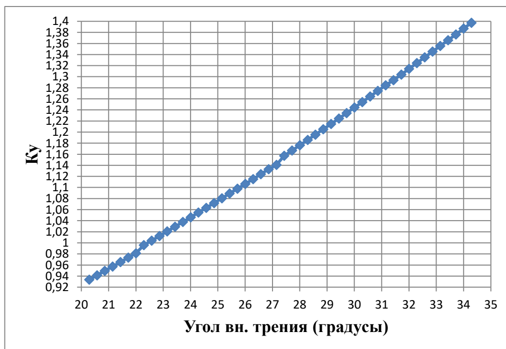
Рисунок 3.6. Зависимость K_u берега от угла внутреннего трения песков, составляющих 17 слой
