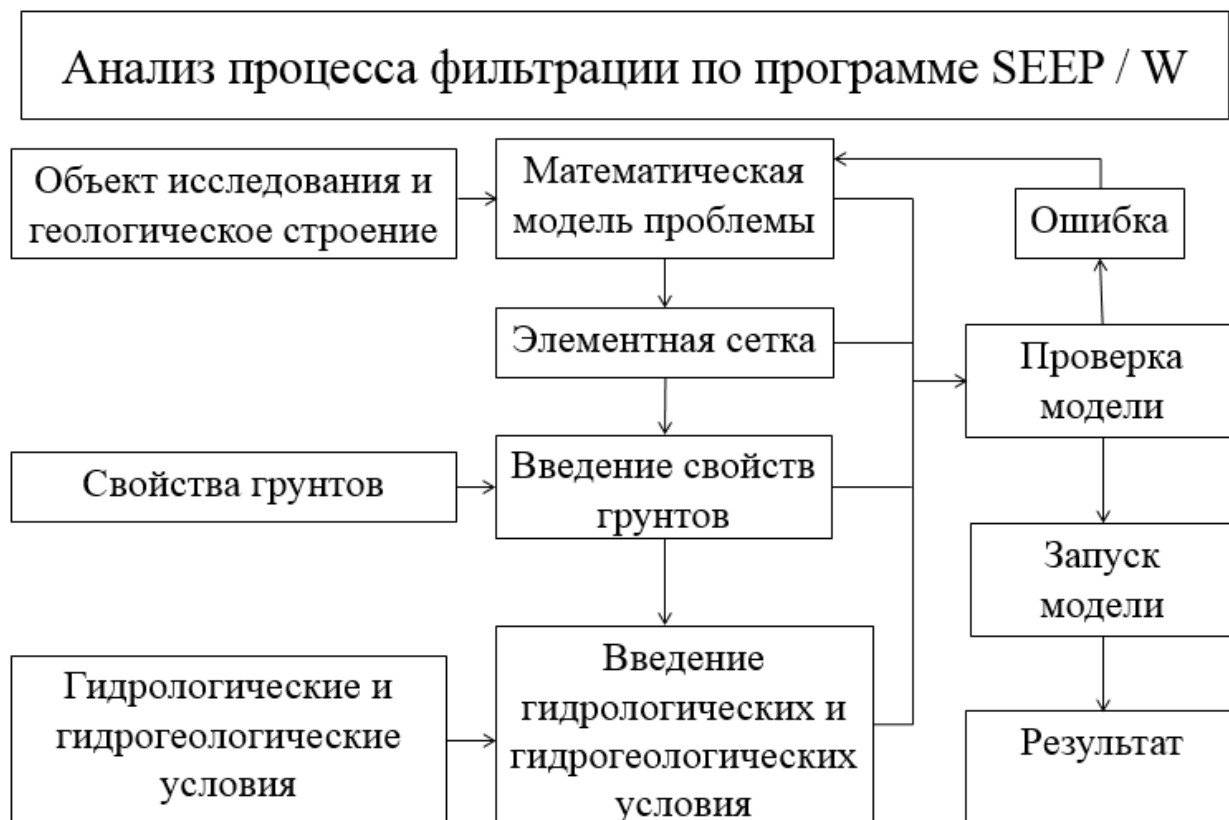
Рисунок 3.1. Схема решения задачи фильтрации
